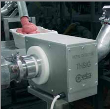
Le système **THS/PL21** est conçu pour la détection dans les produits liquides et visqueux d'éventuels métaux d'origine, magnétiques et non magnétiques
