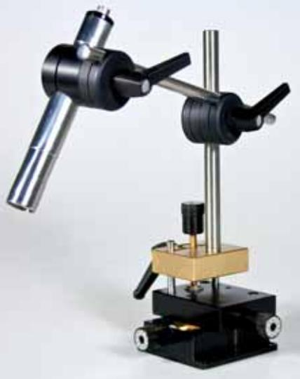
Support ES3M avec réglage micrométrique
