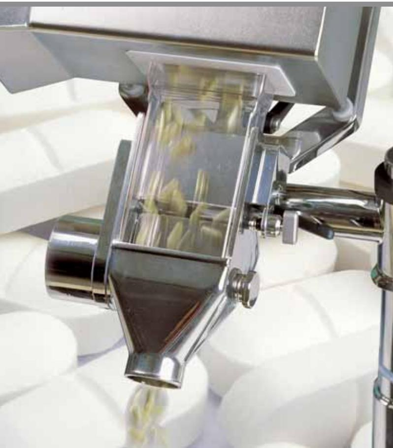
*Le système d'expulsion est pourvu d'un déviateur de type innovant, caractérisé par une rapidité de réponse, une précision d'expulsion des comprimés contaminés et un haut débit de production*
