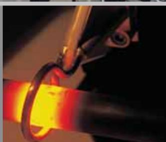
CEIA effectue des recherches et lance la production de générateurs à induction compacts à semi-conducteurs pour le traitement thermique des métaux sans contact.
