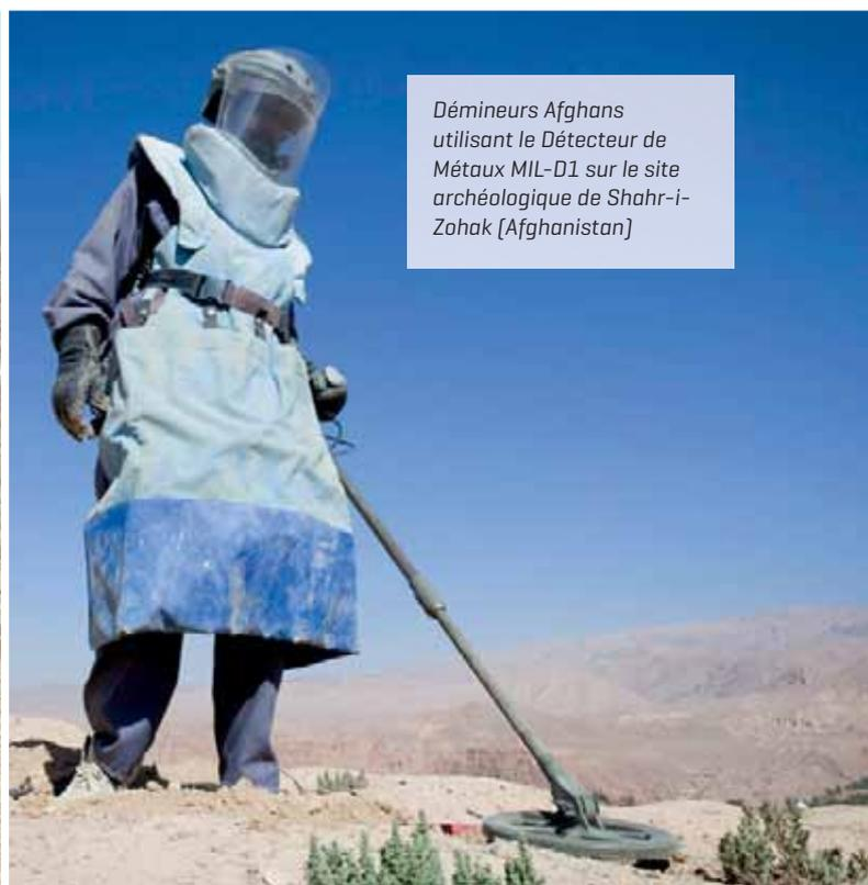
Le Détecteur de Métaux MIL-D1, à haute sensibilité, ne nécessite aucune opération d'étalonnage manuel et, grâce à son système de réglage automatique, est en mesure d'assurer une sensibilité optimale sur tous les terrains.
